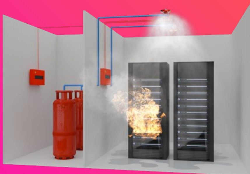
Den automatiska brandbekämpningsenheten "Spider" förhindrar brandens utveckling.
